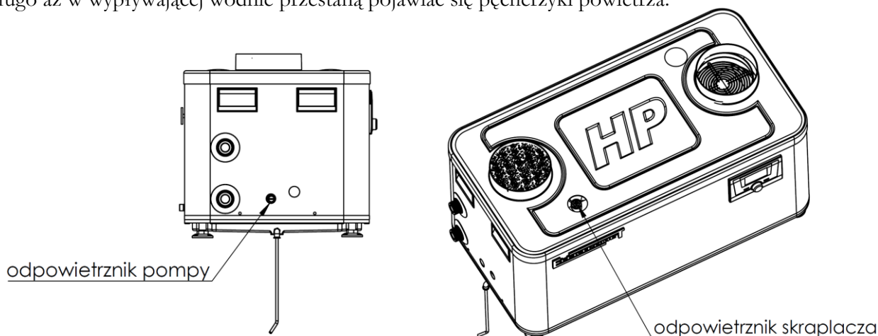
Rys. 7. Odpowietrzanie pompy ciepła.
